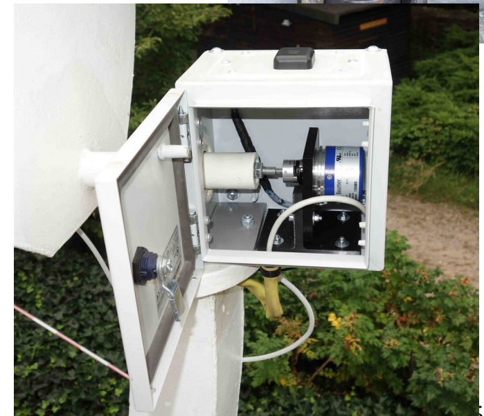
Encoder mit direkter Kopplung der Elevationsachse
