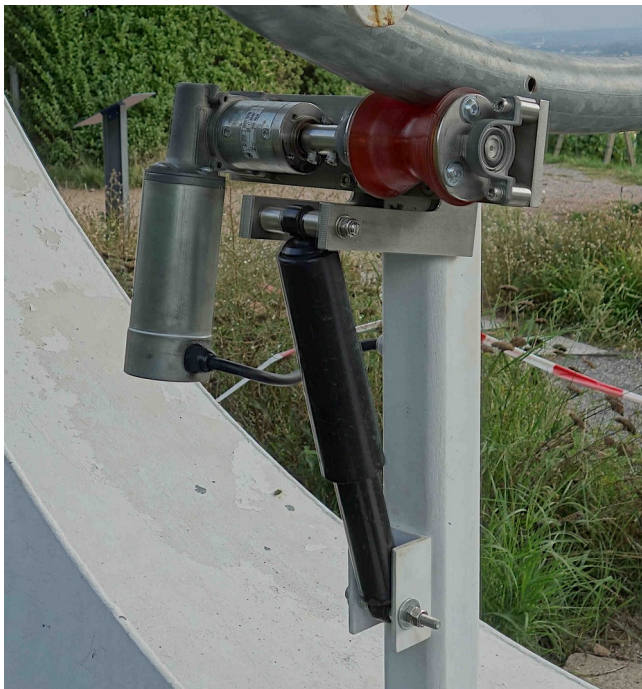
Antrieb der Elevationsachse - Rutschkupplung
